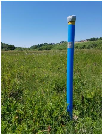
Piézomètre destiné à mesurer les niveaux d'eau dans la zone humide
