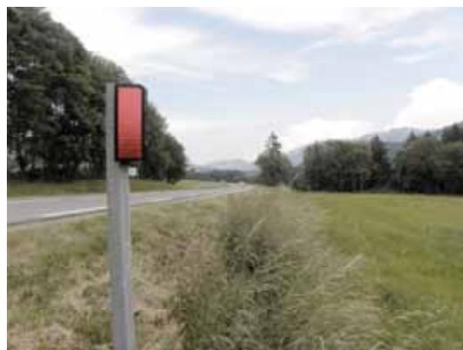
Détecteur thermique de faune (utilisé en Suisse et en Isère). A l'approche d'un animal un signal lumineux avertit l'automobiliste (© cg 38).
